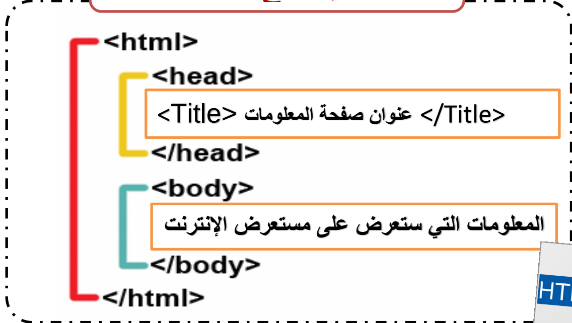
شكل (١١) يوضح بناء Structure ملف لغة الترميز HTML
